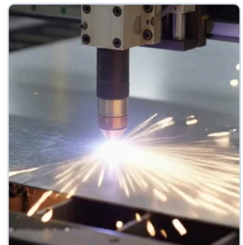
ماكينة البلازما CNC لقص وتشكيل صاج مجاري الهواء
